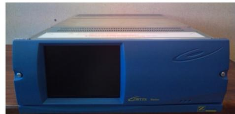
Figure 4 : PC de démodulation (Cortex HDR XXL)
